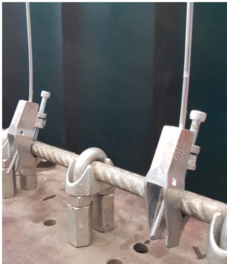
Foto 1: verbinding van gewasdraden aan rond 14 mm met Gripple 90GP in de testopstelling.
