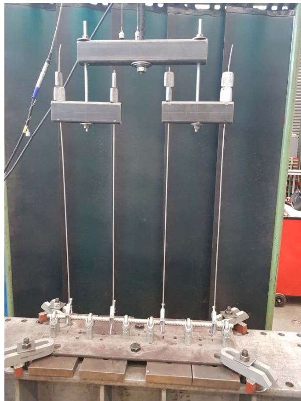
Foto 4: gewasdraadverbinding met Gripple GP90 in de testopstelling voor het onderzoek naar de weerstand tegen wisselende belasting.
