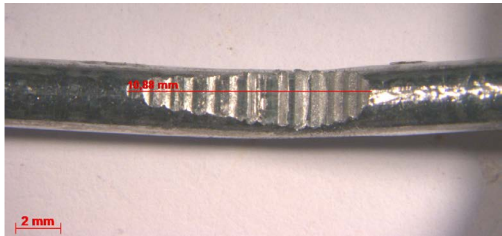
Foto 6: deformatie van gewasdraad Crapal 3,15 mm in de klemverbinding met Gripple GP90, na uitvoering van een statische test.
